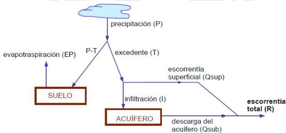
Figura 2.2 Esquema del flujo del agua del modelo Témez
