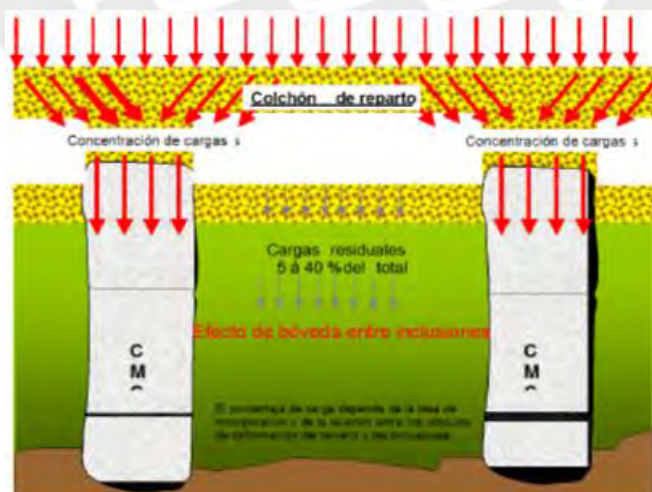
Figura 20. Esquema de transmisión de cargas en el suelo tratado con columnas de mortero. Tomado del “Manual de dimensionado y ejecución de columnas de mortero”, por Menard (España), 2015.
