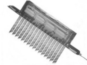
Figura 2.1: Arreglo 3-D de electrodos Michigan [15].
