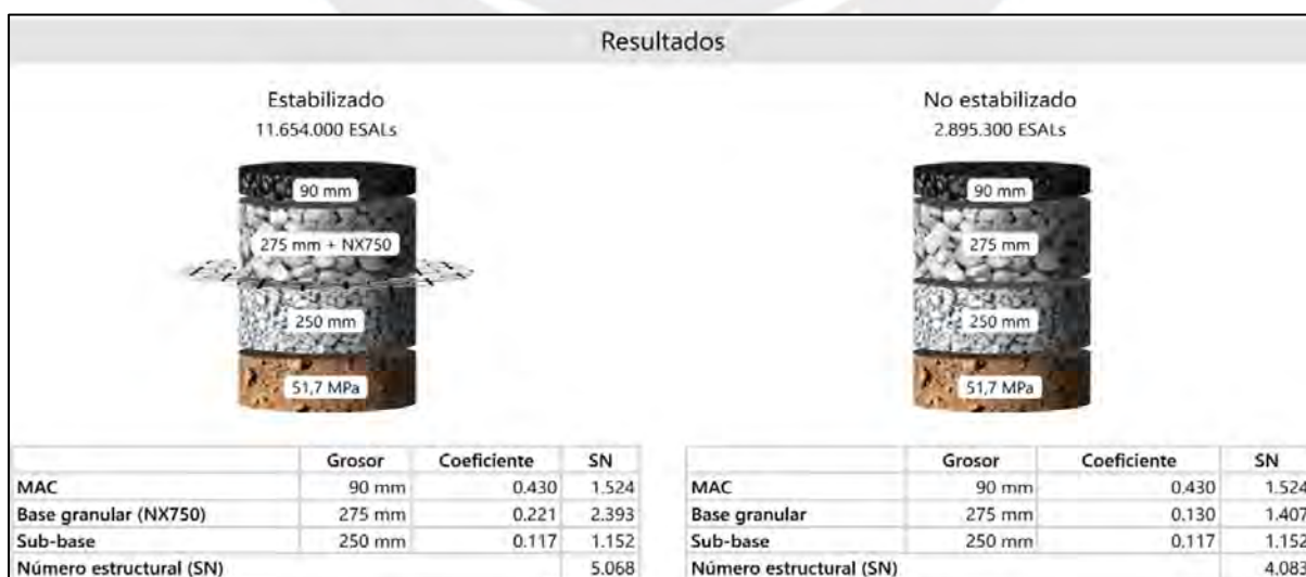
Figura 26. Espesor del pavimento de la Av. San Martín con la geomalla NX750.
