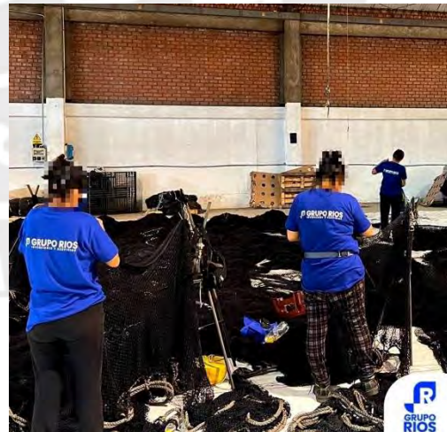
Figura F2: Proceso de reparación y confección de redes de pesca artesanal
