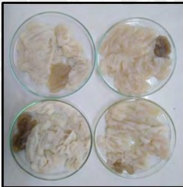
Figura 34. Alginato secado a temperatura ambiente
