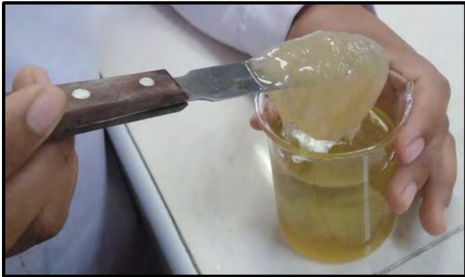
Figura 33. Precipitado de alginato en etanol en forma de gel.
