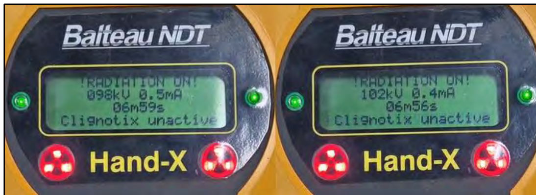
Figura 61. Variación de voltaje a 100 kV
