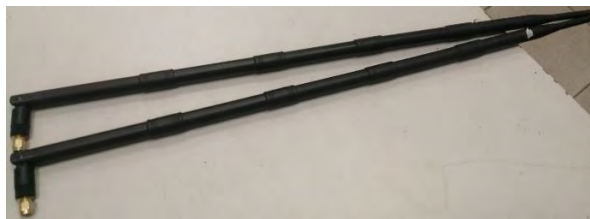
Figura 3.3 - Antenas omnidireccionales de 10 dBi. Fuente: Elaboración propia
