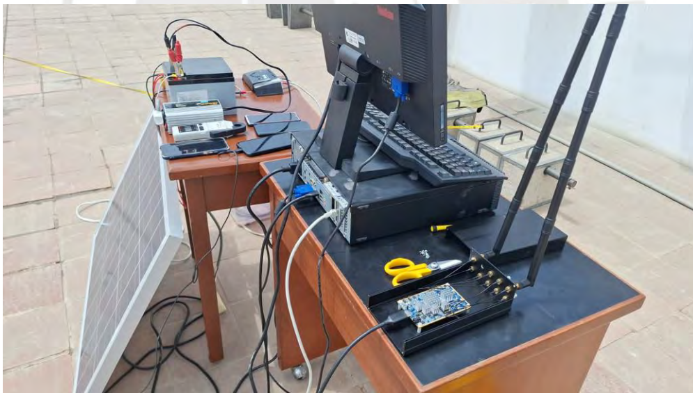
Figura E4 - Escenario de pruebas con equipos de telecomunicaciones (equipo SDR con antenas) y celulares de prueba. Fuente: Elaboración propia
