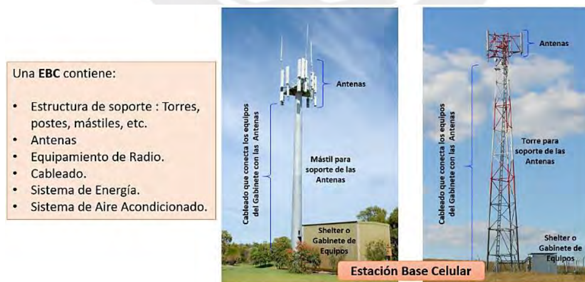
Figura 1.7 - Componentes de una estación base celular. Fuente: [22]
