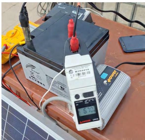
Figura E5 - Consumo de corriente con equipos conectados. Fuente: Elaboración propia
