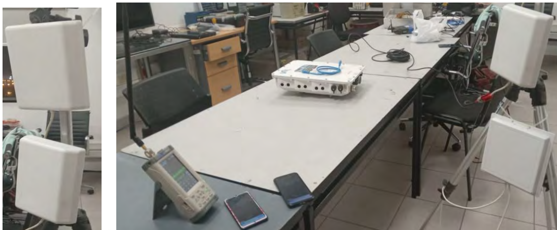
Figura D1 - Entorno de pruebas con antenas directivas. Fuente: Elaboración propia
