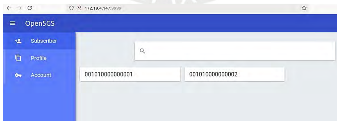
Figura 3.32 - Configuración de ambos SIM en Open5GS. Fuente: Elaboración propia
