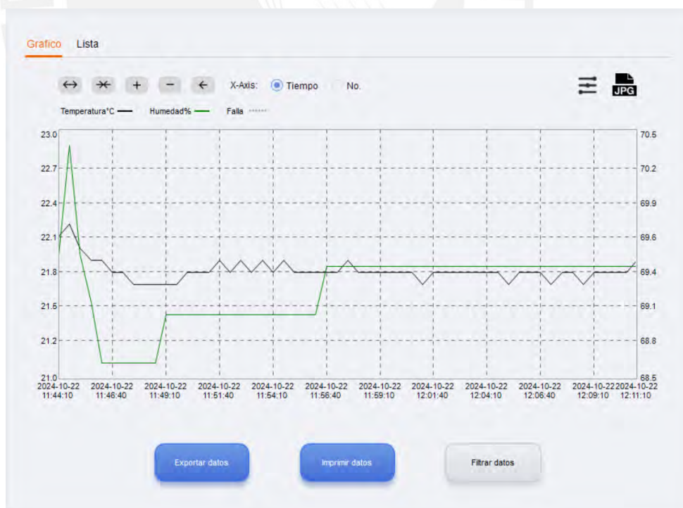
Figura 21: Gráficos de temperatura y humedad relativa en el software de ElitechLog para el Termohigrómetro RC-4HC
