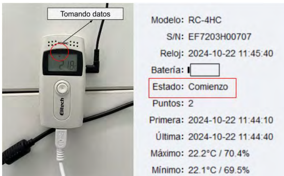
Figura 18: Verificación del estado de captura en el software de ElitechLog para el Termohigrómetro RC-4HC
