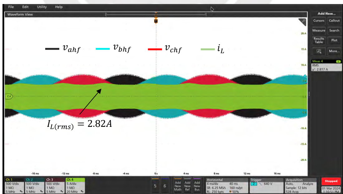
Figura 4.28 : Tensiones moduladas y la corriente de alta frecuencia en 1 kW
