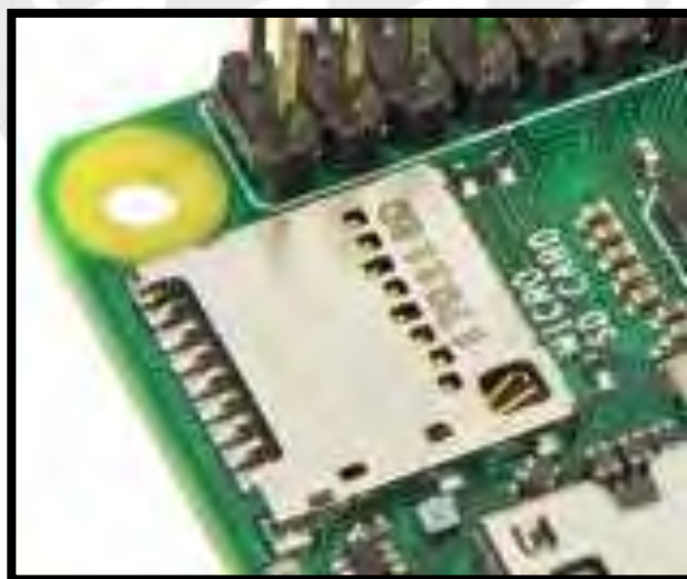
Ilustración 2. Ranura SD RPI Zero W
