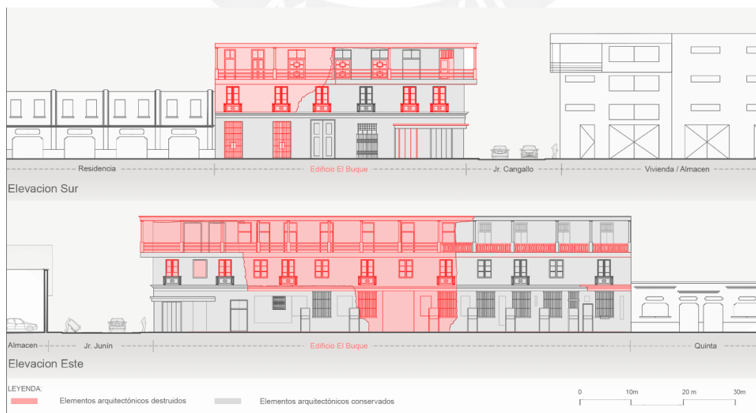
Imagen 4: Destrucción de las fachadas de la casona “El Buque”. Fuente: Elaboración propia basada en fotografías actuales del inmueble.
