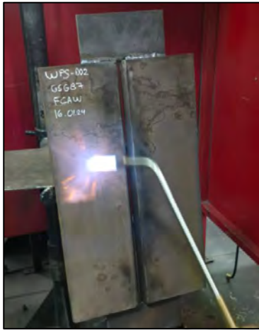
Figura 64. Precalentamiento de acero
