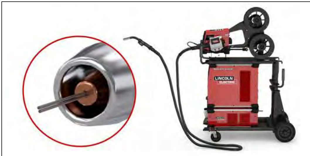
Figura 9. Máquina de soldar POWER WAVE con tecnología HyperFill
