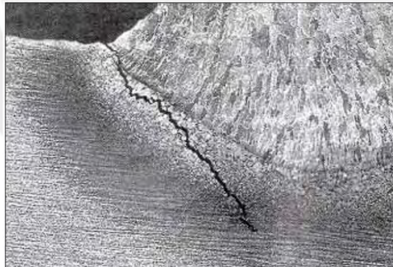
Figura 3. Unión soldada con fisuración iniciada en la zona ZAC.
