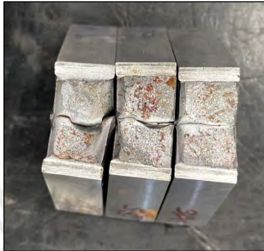
Figura 88. Probetas de impacto de cupón 1 (soldadura FCAW-G Hyperfill) puntos S4, S5 y S6 correspondientes a la zona ZAC.
