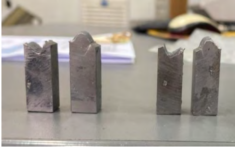
Figura 57. Vista lateral de probetas ensayadas a -80\text{ }^{\circ}\text{C}
