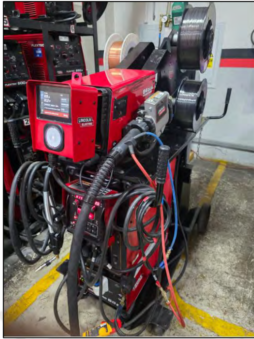
Figura 33. Fuente de poder Power Wave® S500 + módulo de refrigeración Cool Arc® 50
