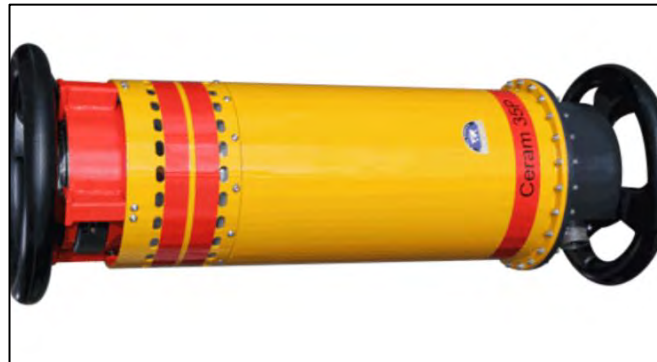
Figura 44. Tubo generador de rayos X Balteau NDT Ceram 35
