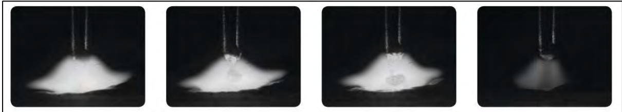
Figura 8. Ciclo de soldadura en el proceso Hyperfill – etapas de transferencia de la gota al baño de fusión.
