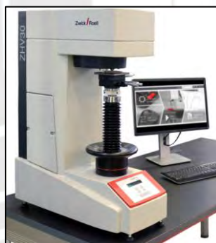
Figura 50. Durómetro Zwick Roell ZHV30
