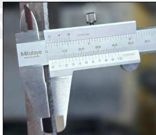
Figura 63. Altura de talón de 2.5 mm
