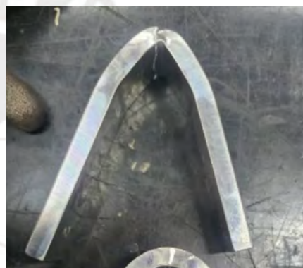
Figura 80. Foto lateral de probeta de doblado rota, proceso FCAW-G.
