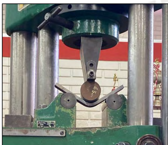
Figura 81. Ejecución de ensayo de doblado
