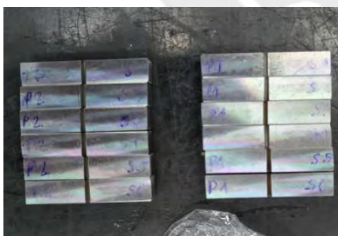
Figura 86. Probetas de impacto mecanizadas.
