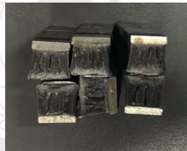
Figura 55. Sección de probetas ensayadas a -60\text{ }^{\circ}\text{C} Figura 56. Sección de probetas ensayadas a -20\text{ }^{\circ}\text{C}
