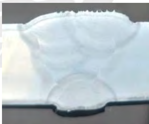
Figura 90. Probeta de barrido de durezas de cupón FCAW-G
