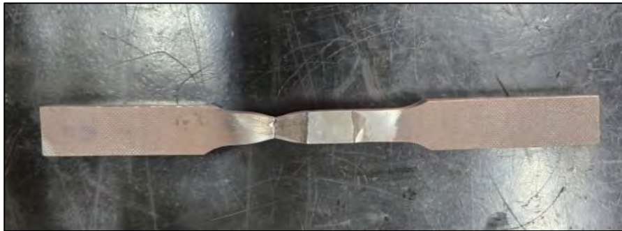
Figura 83. Rotura dúctil de probeta de tracción en zona del material base
