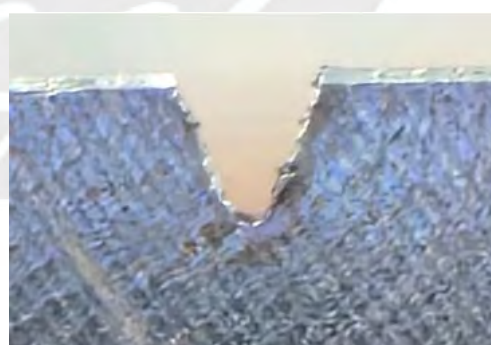
Figura 87. Detalle de entalla de probeta charpy-v
