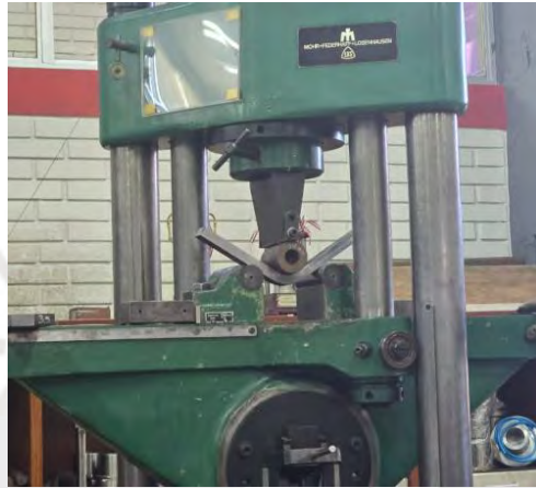
Figura 47. Matriz y punzón de doblado a utilizar para las pruebas.
