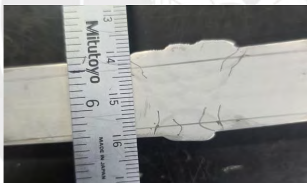
Figura 91. Marcado de probetas previo a la ejecución de ensayo de dureza Vickers
