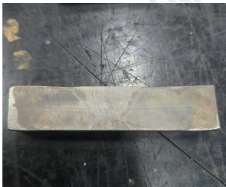
Figura 84. Probeta con cordón de soldadura y zona zac revelados.
