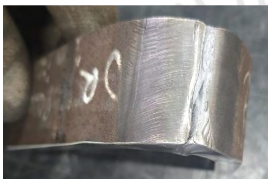
Figura 79. Probeta de doblado rota, proceso FCAW-G
