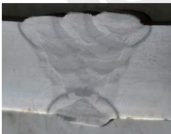
Figura 89. Probeta de barrido de durezas de cupón FCAW-G Hyperfill
