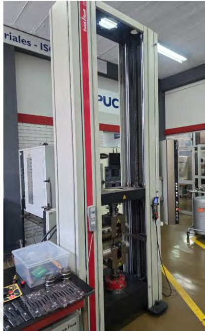
Figura 24. Máquina de tracción universal ZWICK ROELL Z250
