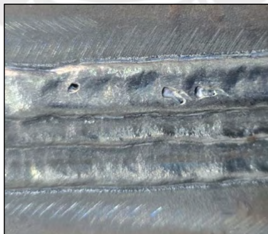
Figura 66. Porosidad vermicular en el extremo del cupón soldado con FCAW
