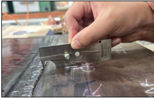
Figura 67. Medición de socavaciones
