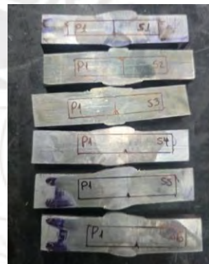
Figura 85. Probetas marcadas para mecanizado.
