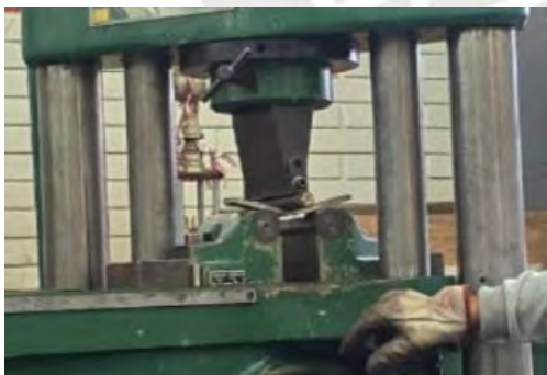
Figura 77. Ejecución de ensayo de doblado
