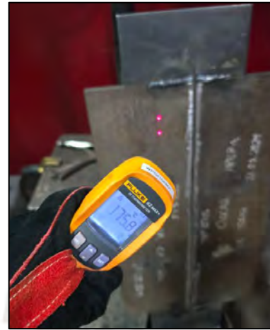
Figura 65. Lectura de pirómetro de 175 °C
