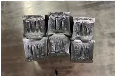
Figura 55. Sección de probetas ensayadas a -60\text{ }^{\circ}\text{C} Figura 56. Sección de probetas ensayadas a -20\text{ }^{\circ}\text{C}
