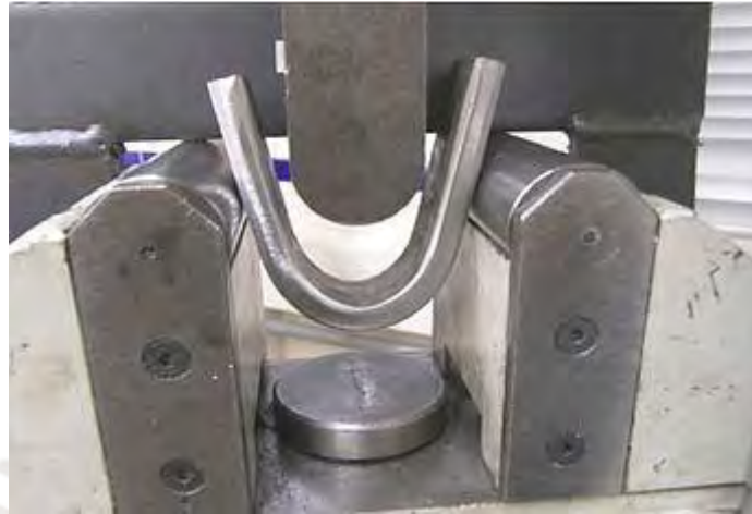
Figura 19. Doblado de probeta de soldadura mediante punzón y guía con rodillos
