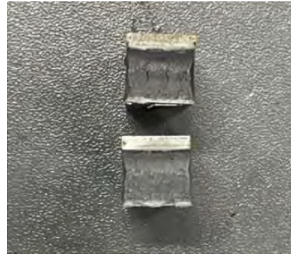
Figura 58. Sección de probeta ensayada a -80\text{ }^{\circ}\text{C}
