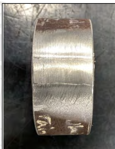
Figura 82. Foto frontal de probeta extra de doblado de raíz FCAW-G
