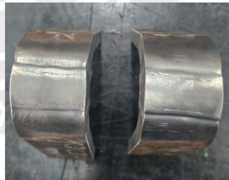
Figura 78. Foto frontal de probetas de doblado de raíz – Soldadura FCAW-G Hyperfill
