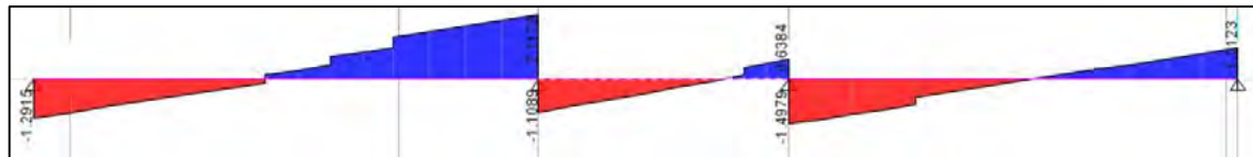
Figura 4.4. Diagrama de fuerza cortante
