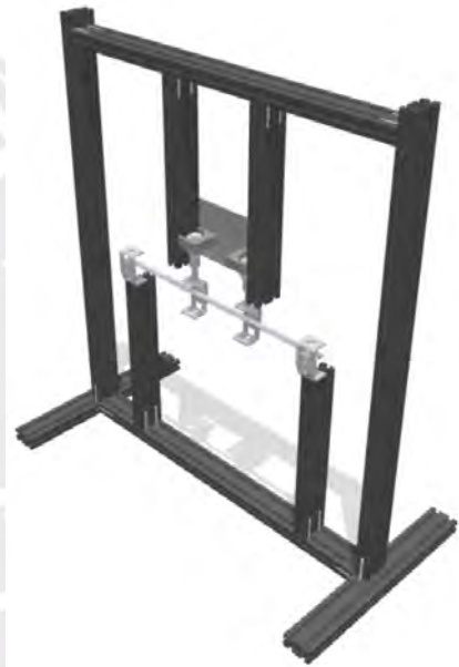
Figura 4.2: Modelo CAD del banco de pruebas de carga alternante
