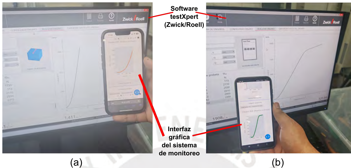
Figura 5.31: Comparación cualitativa entre los gráficos obtenidos por el software testXpert y la aplicación GUI del sistema de monitoreo
