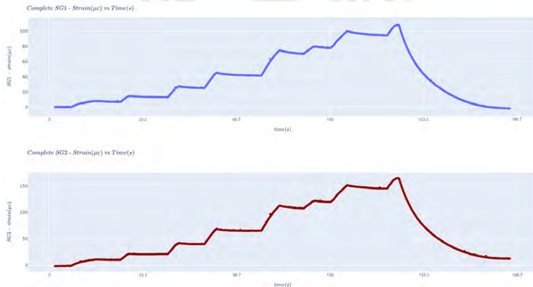
Figura 5.26: Gráfica deformación vs tiempo de dos strain gauge en un recipiente a presión
