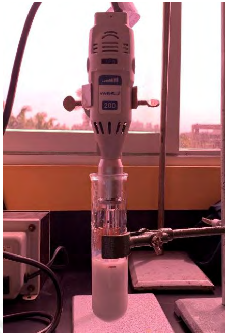
Figura 9 Dispersión partículas de \text{TiO}_2 en electrolito basado en \text{ZnCl}_2 con el homogeneizador VWR 200.
