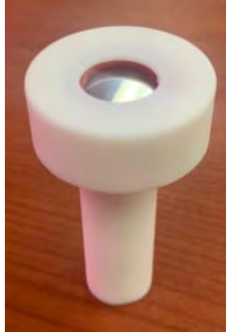
Figura 10 Portaelectrodo de teflón con contacto metálico interno y sustrato de acero.
