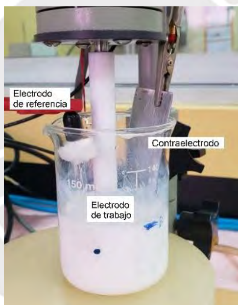
Figura 12 Arreglo experimental para el estudio de la cinética de la deposición por voltametría de barrido lineal
