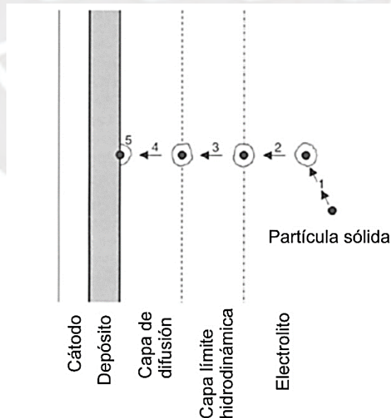
Figura 5 Pasos del proceso de codeposición e incorporación de una partícula sólida en el depósito 22 (Adaptado de Electroplating 2004, 87–140)
