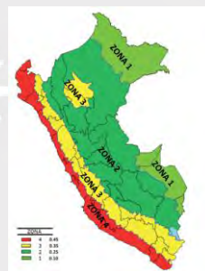
Figura 4.1 Zonificación sísmica del Perú Nota. Adquirido de “E.030 Sismorresistente” (RNE).
