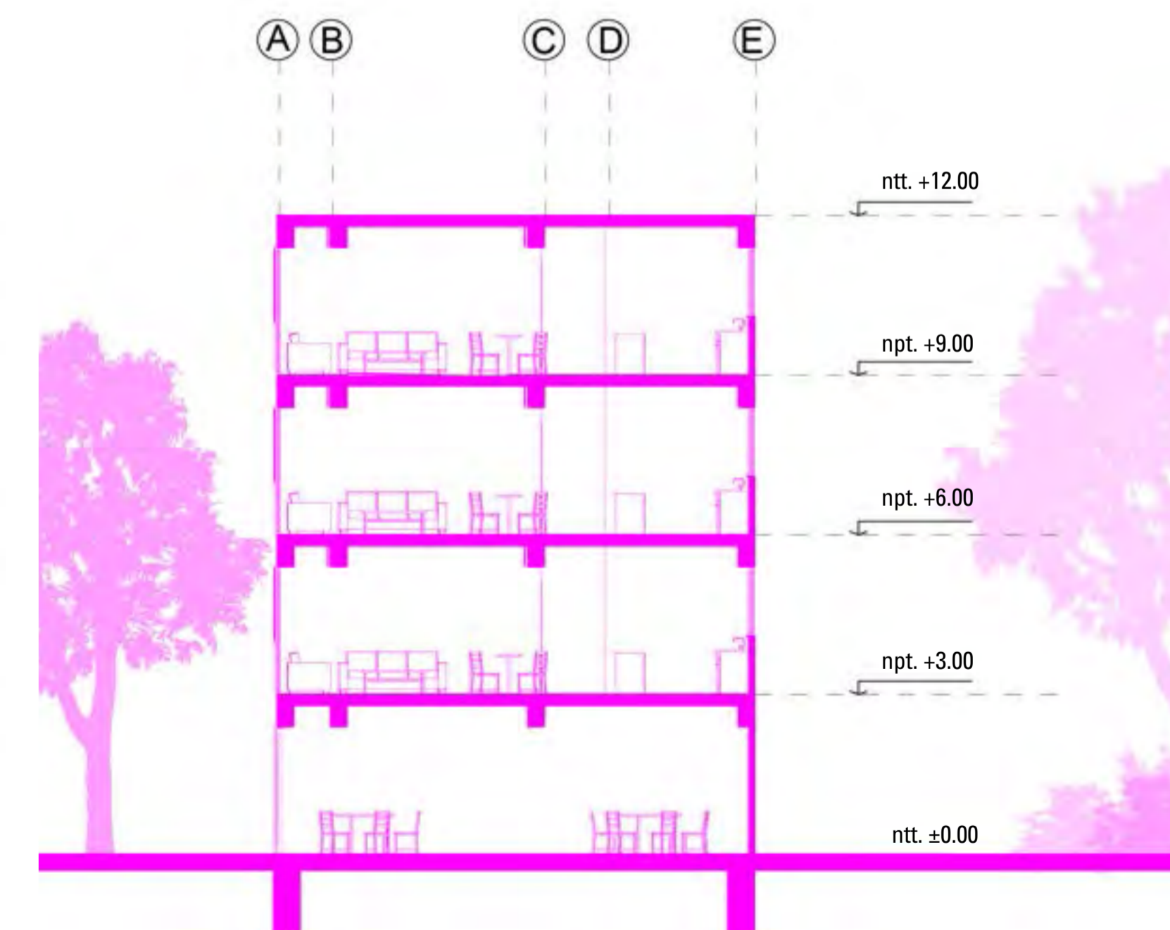
CORTE (Ventilación cruzada en el comedor-sala-cocina) esc. 1/100
