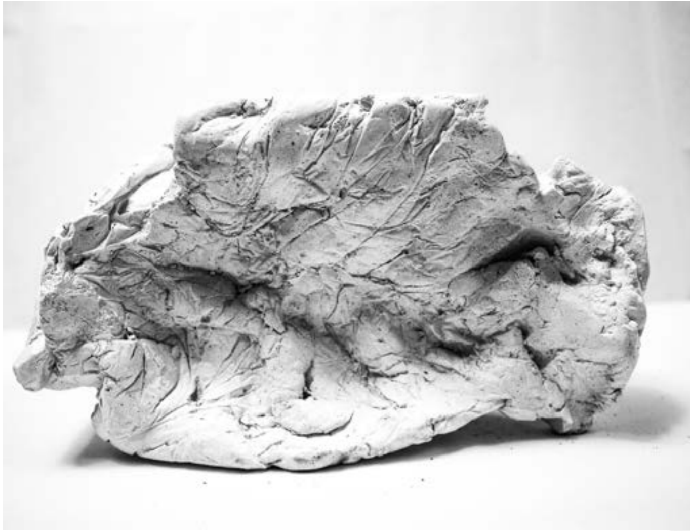
Segunda prueba sobre concreto. Esta vez se intentó diseñar todas las caras. Además, se empleó papel para dar forma a los vacíos dentro del encofrado.
