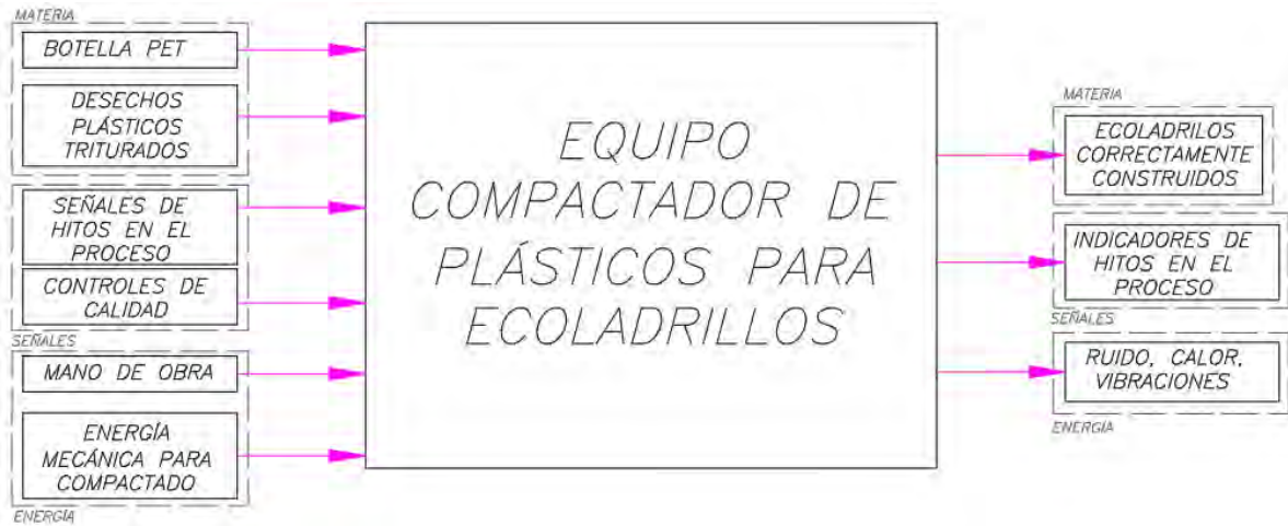
Figura 16. Caja negra del sistema a diseñar
