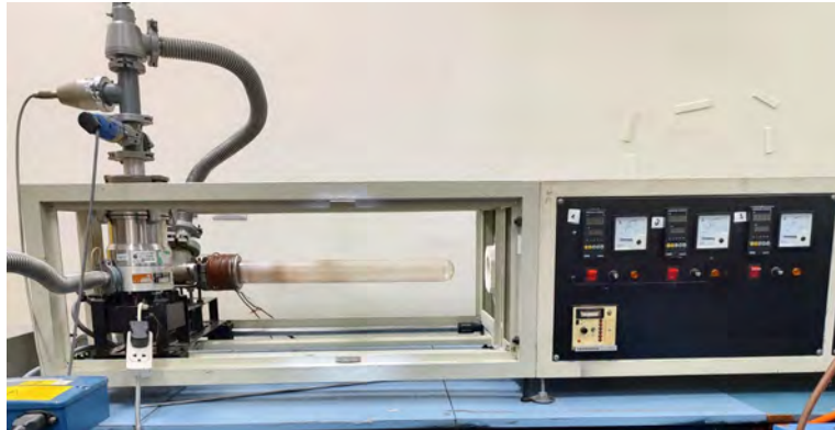
Figura 3.19: Horno tubular. Consiste en un tubo de cuarzo con capacidad de vacío hasta 4 \times 10^{-5} mbar, además permite inyectar un flujo gas contante a baja presión durante el tratamiento térmico.
