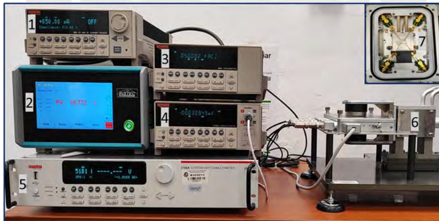
Figura 3.1: Sistema de medición de propiedades eléctricas compuesto de 1) Fuente de corriente, 2) Controlador de temperatura, 3) Picoamperímetro, 4) Nanovoltímetro, 5) Conmtador con tarjeta de efecto Hall, 6) Imán y 7) Plataforma de medida. Adicionalmente el sistema tiene capacidad de conectar bomba de vacío, bomba de agua y bomba de nitrógeno líquido, depende de la temperatura de medida.
