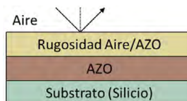
Figura 3.17: Modelo óptico, se usó silicio como sustrato, una capa de AZO modelada con osciladores de Tauc Lorentz y una capa de rugosidad (EMA) entre el AZO y el aire.
