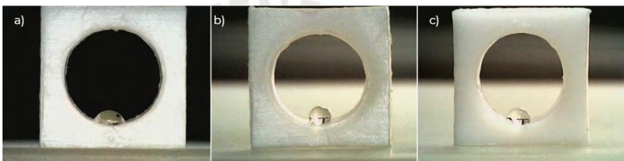
Figura 3.8: Evolución del ángulo de contacto con agua destilada sobre superficies de PTFE tratadas con plasma atmosférico. a) Muestra sin tratamiento, b) muestra tratada al día 1, y c) muestra evaluada 21 días después del tratamiento.
