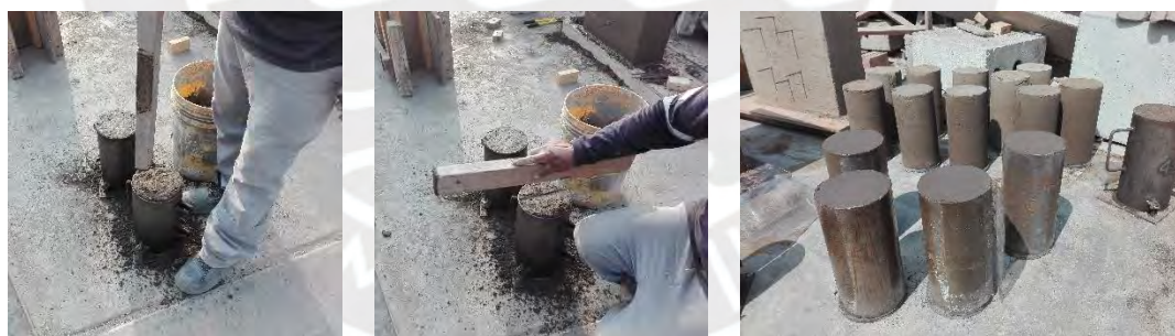
Figura 21. Elaboración de probetas cilíndricas de tierra apisonada en molde estándar de 6"x 12" [150 mm x 300 mm]
