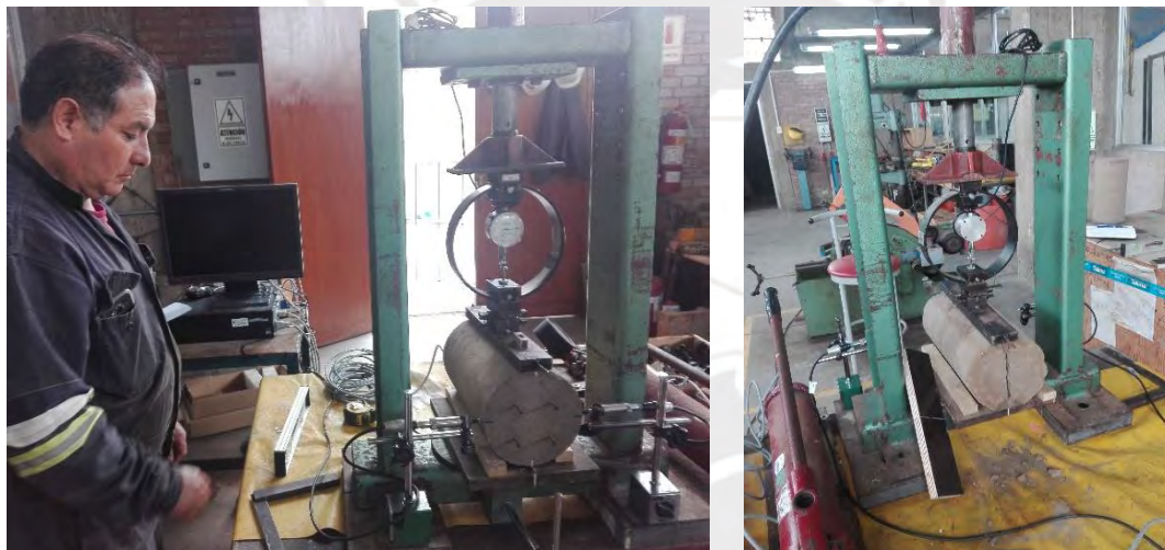
Figura 24. Primer intento de calibración del ensayo con anillo de carga acondicionado
