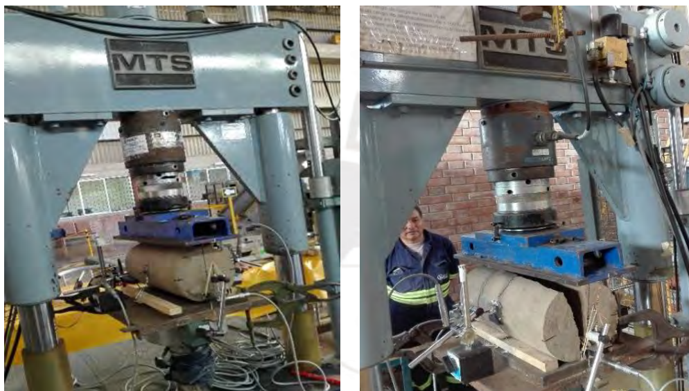
Figura 25. Instrumentación y modo de falla típico en probeta cilíndrica tras calibración de carga y deformímetros acondicionados para valores esperados
