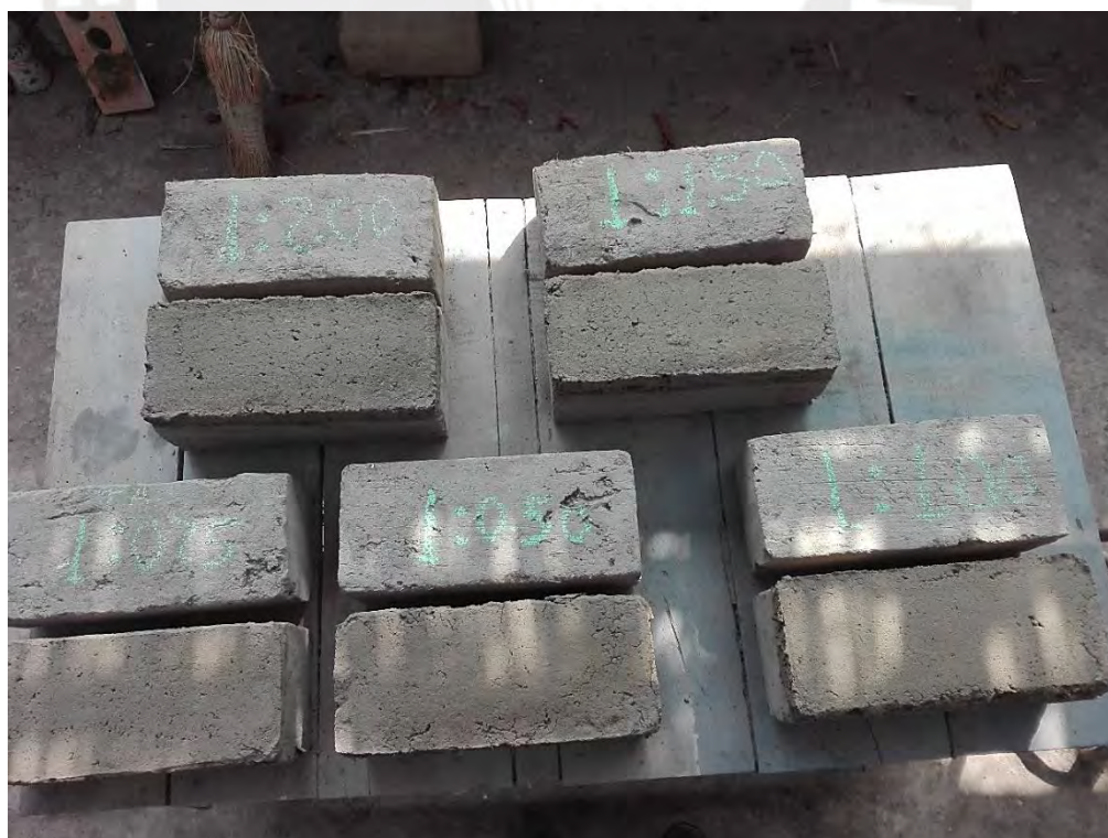
Figura 4. Resultado final del ensayo de Control de Fisuración. Proporción Suelo: Arena gruesa
