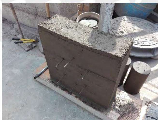
Figura 8. Murete fresco con elementos incrustados para posterior ensayo de compresión diagonal y registro de deformaciones
