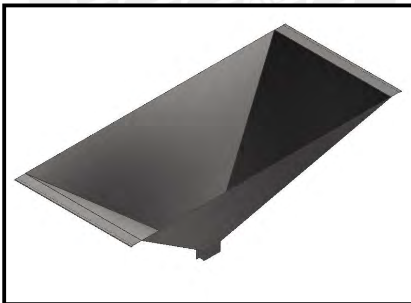
Figura 30. Tolva de alimentación – sistema de suministro de masterbatch.
