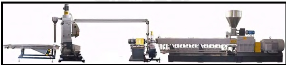
Figura 8. Máquina extrusora – peletizadora bajo el agua modelo TSE (Haisi, s.f.)
