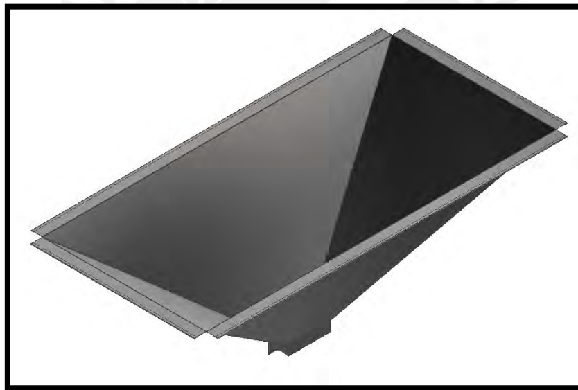
Figura 24. Tolva de alimentación – sistema de suministro de escamas.
