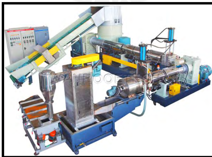
Figura 10. Máquina extrusora – peletizadora modelo PNHS (Wanrooetech, s.f.)
