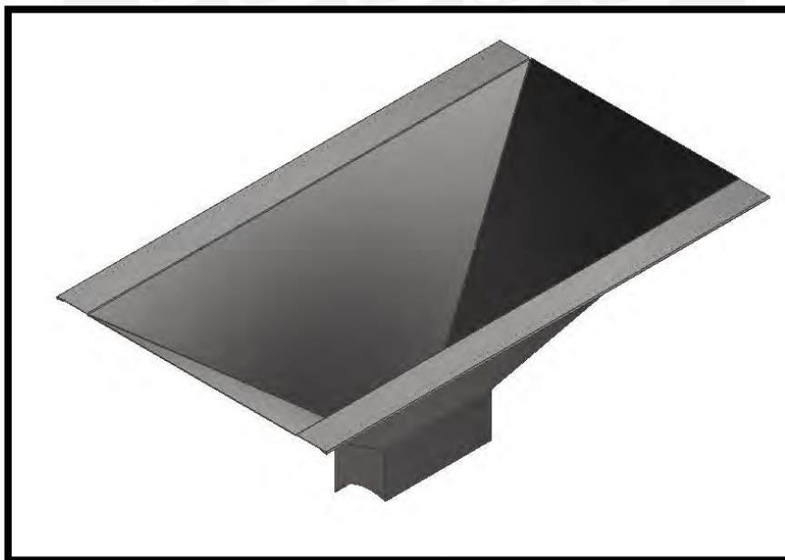
Figura 38. Tolva de alimentación – sistema de extrusión.
