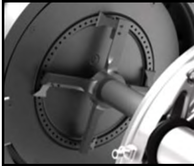
Figura 7. Cuchilla estrella para peletizadora (Cuchillas Castillo, s.f.)
