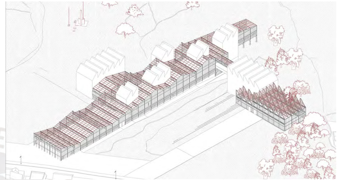
ISOMETRÍA CONSTRUCTIVA 6. Colocación de viguetas y armado de la cubierta de termotecho
