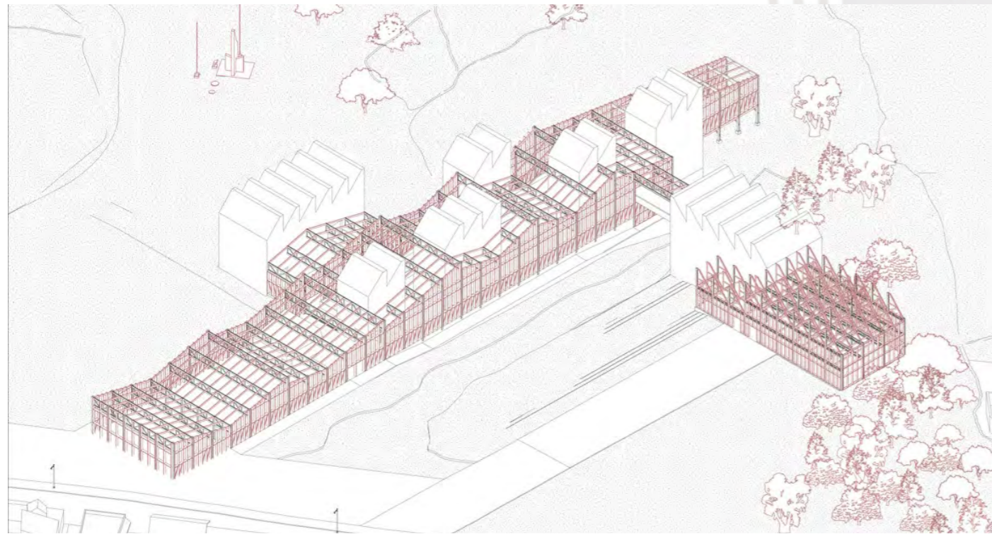
ISOMETRÍA CONSTRUCTIVA 5. Arriostre de la nave estructural mediante montantes verticales, horizontales y diagonales
