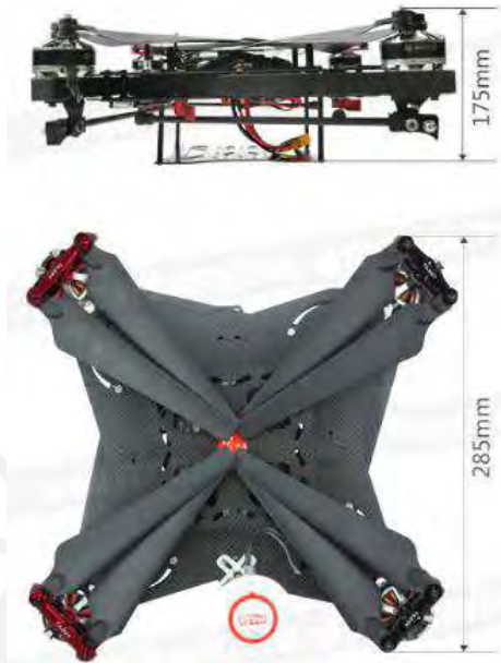
Figura 54. Medidas del fuselaje compacto del dron Fuente: Foxtech
