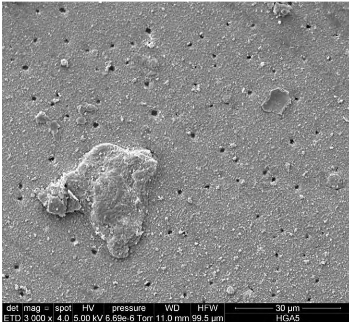
Figura 5.24. Imagen de la superficie del hidrogel HGA5 con el microscopio electrónico de barrido (SEM) luego de 24 horas de exposición a la bacteria Staphylococcus aureus a magnificación de 3000x.
