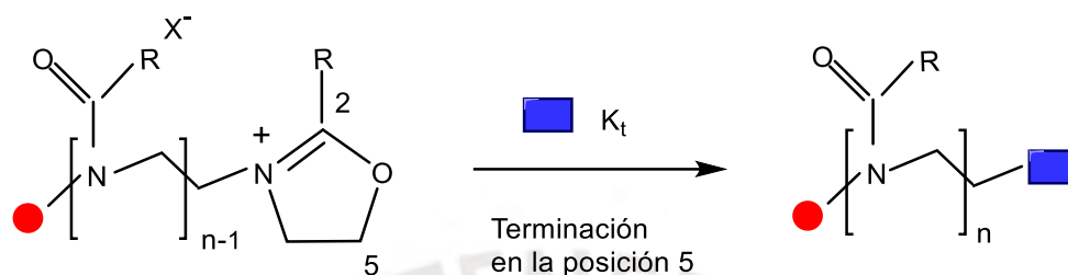
Figura 1.10. Mecanismo de terminación de PCAA donde un agente terminador (rectángulo azul) ataca la posición 5 de la cadena propagante con el agente iniciador (círculo rojo).
