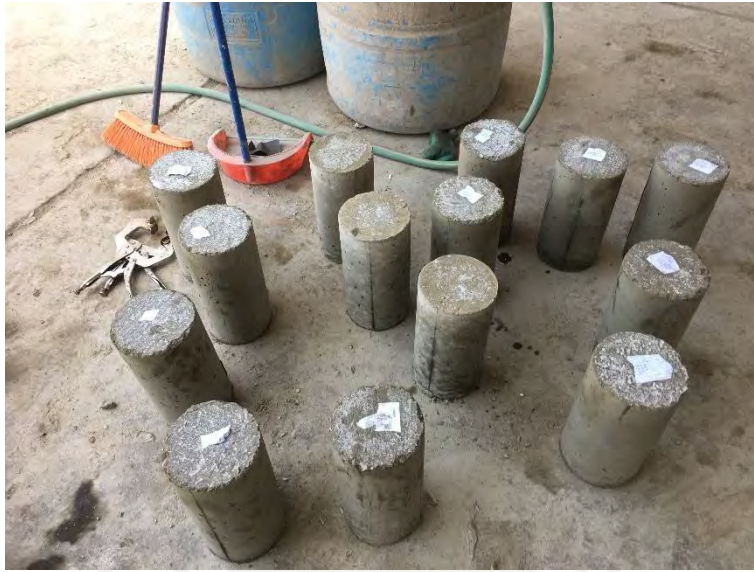
Foto A 9. Desencofrado de las probetas de concreto
