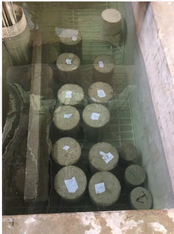
Foto A 10. Curado de las probetas de concreto
