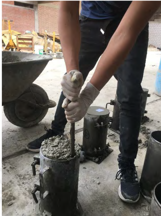
Foto A 7. Vaciado y varillado de las probetas de concreto
