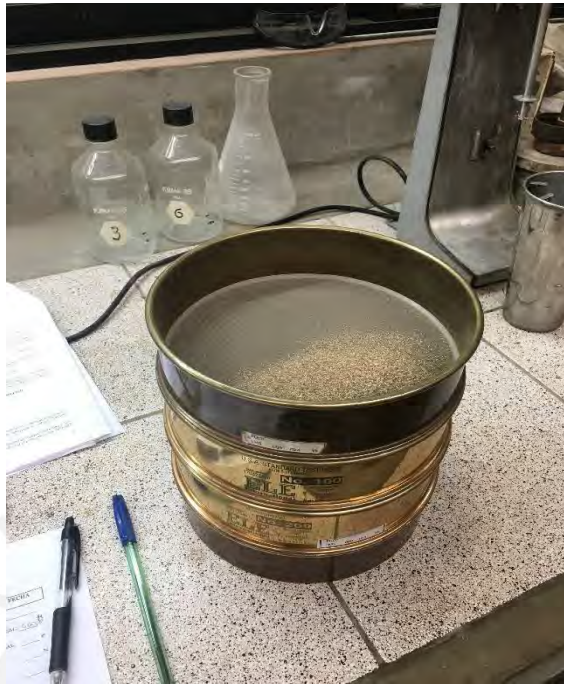
Figura 8. Tamices para el agregado fino
