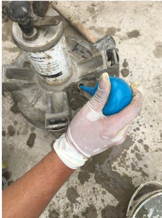
Foto A 6. Inyección de agua en el medidor de aire
