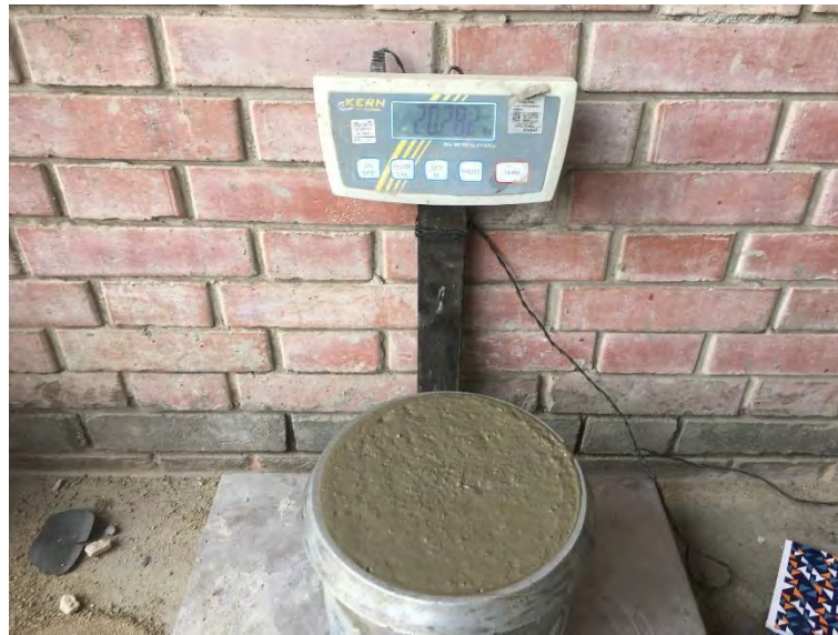
Figura 18. Ensayo de Peso Unitario del concreto fresco
