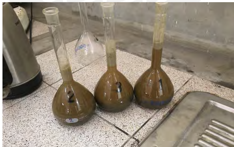
Figura 12. Ensayo de peso específico y absorción del relave minero
