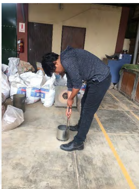
Figura 10. Ensayo de Peso Unitario del agregado fino
