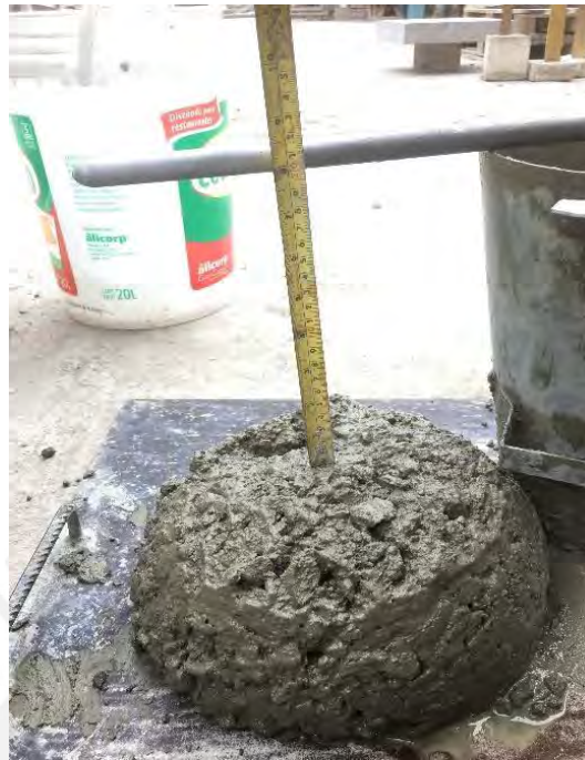
Figura 17. Ensayo de Slump del concreto fresco
