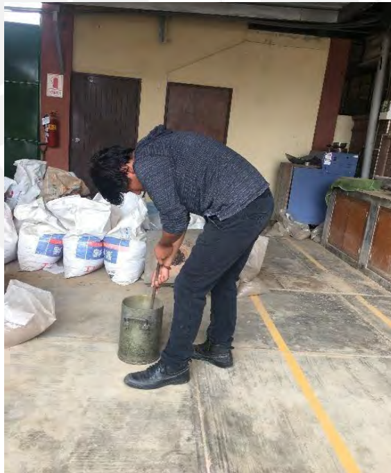
Figura 7. Ensayo de Peso Unitario del agregado grueso
