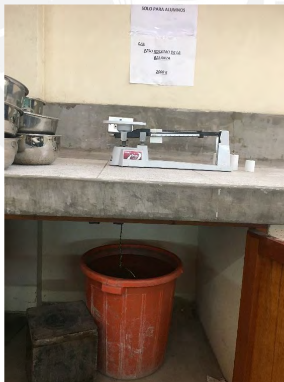
Figura 6. Equipo para el ensayo de Peso específico y Absorción del agregado grueso
