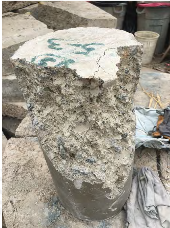
Foto A 13. Falla por compresión de la probeta de concreto
