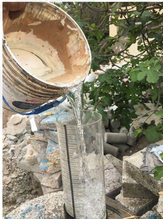
Foto A 12. Vaciado de agua en el permeámetro de carga variable
