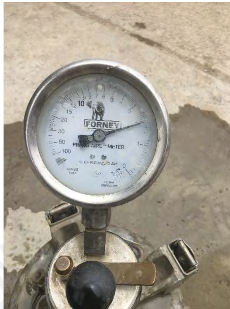
Figura 19. Ensayo de Contenido de Aire del concreto fresco
