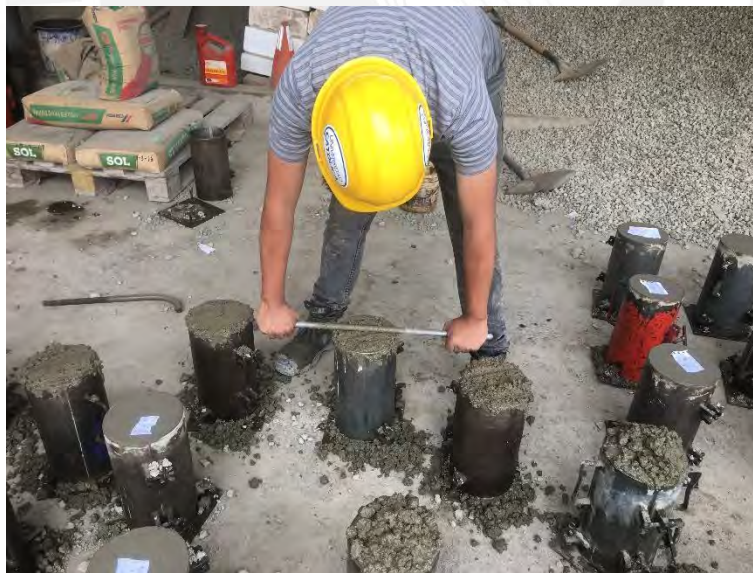
Foto A 8. Enrasado de las probetas de concreto
