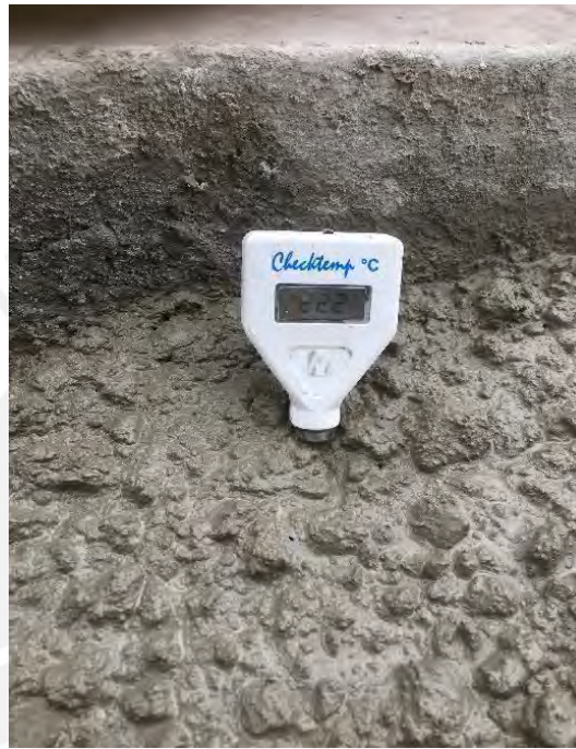
Figura 16. Ensayo de temperatura del concreto fresco
