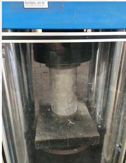
Figura 20. Ensayo de compresión axial
