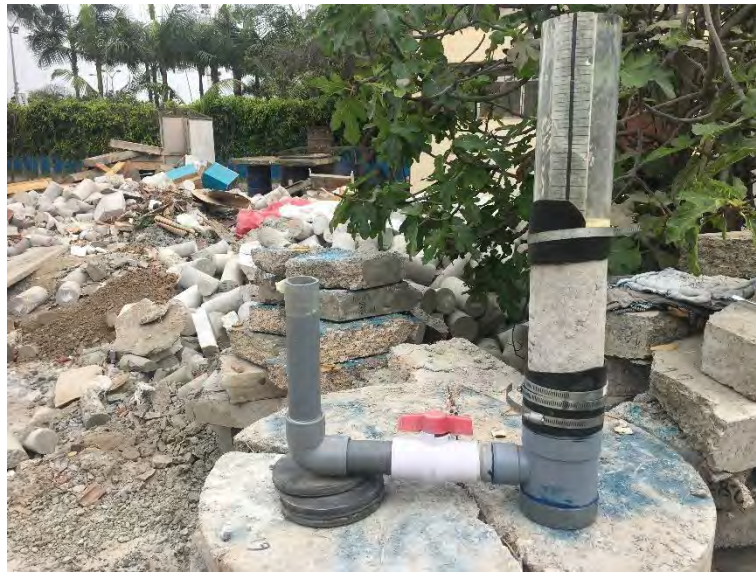
Foto A 11. Ensayo de permeabilidad del concreto
