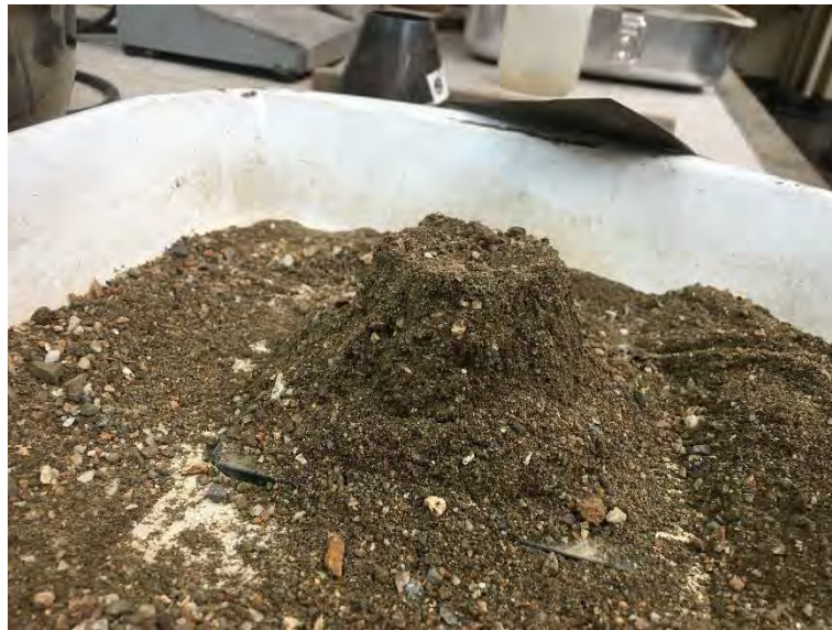
Foto A 3. Relave minero para la elaboración del concreto
