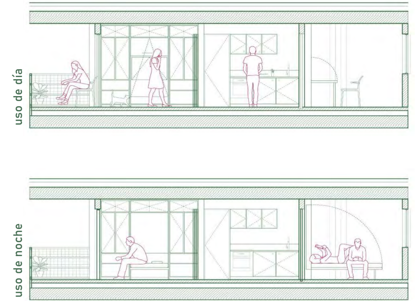
D. vivienda flexible capaz de adaptarse a las necesidades de la familia shipibo-konibo
