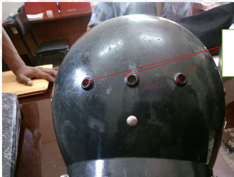
SISTEMA DE INGRESO DE VENTILACIÓN
