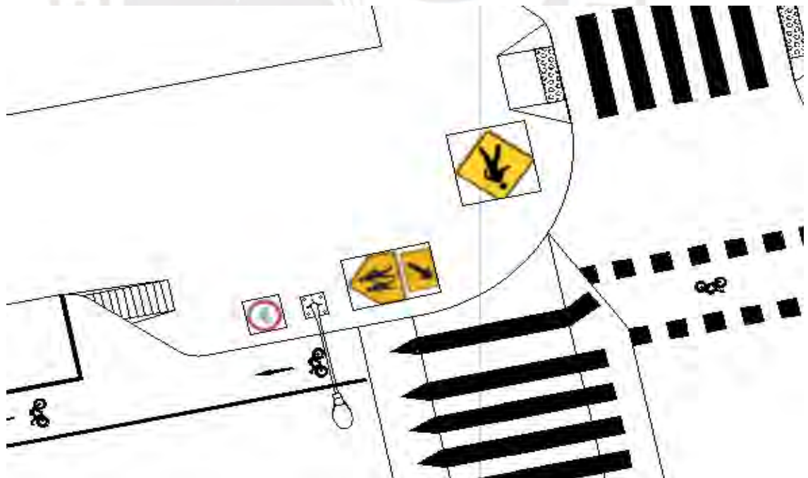
Figura 39. Rampas con relieve, señalización horizontal y vertical de cruces peatonales y faroles cercanos a ciclovía. Tomada y hecha en Autocad.
