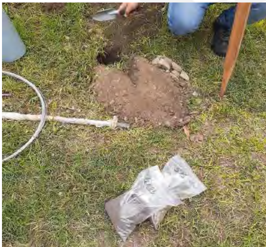
Foto 4 Toma de muestra de suelo superficial y suelo a profundidad. Fuente propia
