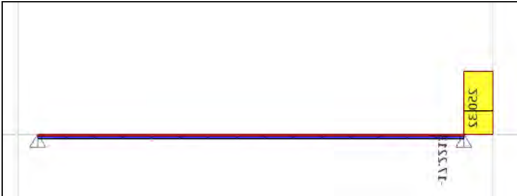
Figura 9.5. DFC de viga de cimentación VC-01
