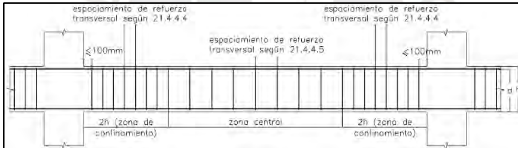
Figura 6.2. Requerimientos de estribos en vigas (Norma E.060)
