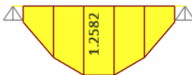
Figura 5.1. DMF de losa maciza en estudio (ton.m)
