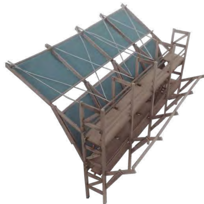
9 Estructura final del dispositivo atrapaniebla, conformada por una base de piedra (asiento y almacenamiento de agua), vigas y columna de madera pino, cables tensores y malla raschel de 60%.
