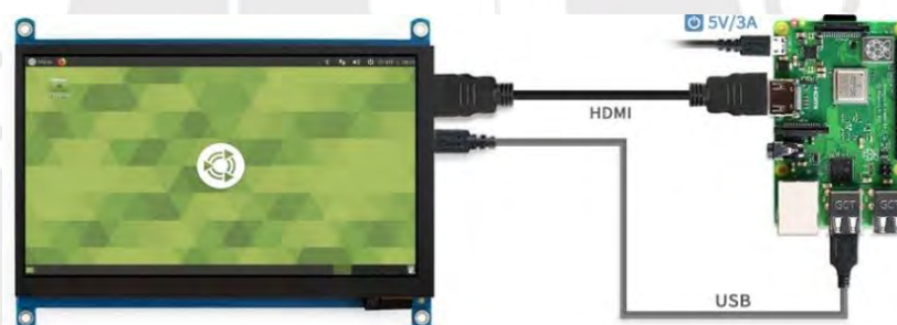
Figura 3.17: Circuito de conexión entre pantalla táctil y Raspberry 27 .
