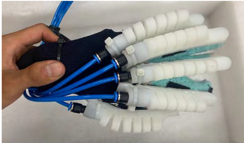
Figura 4.7: Guante neumático de rehabilitación de dedos
