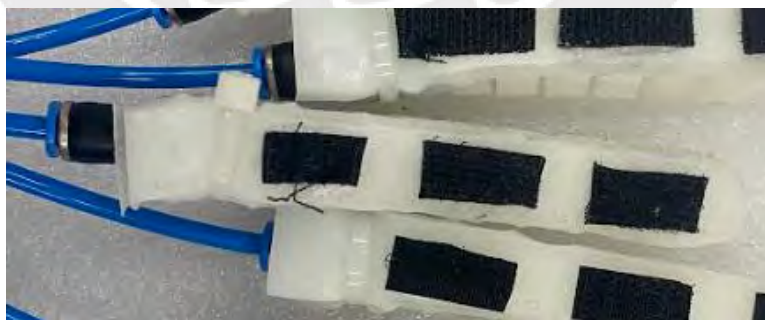
Figura 4.6: Distribución de velcro sobre actuador construido.
