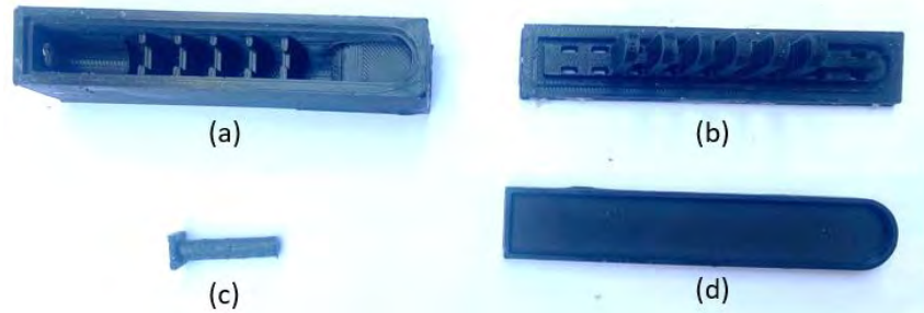
Figura G.2: Partes de molde fabricado para actuador blando: (a) Inferior, (b) Superior, (c) Conducto, (d) Inferior.
