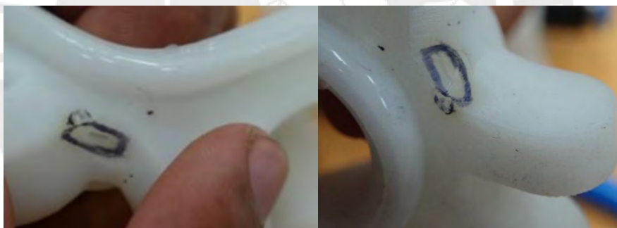
Figura 5.4: Ruptura en dos actuadores.
