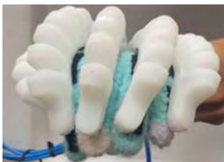
Figura 5.5: Funcionamiento del guante robótico de rehabilitación de dedos.
