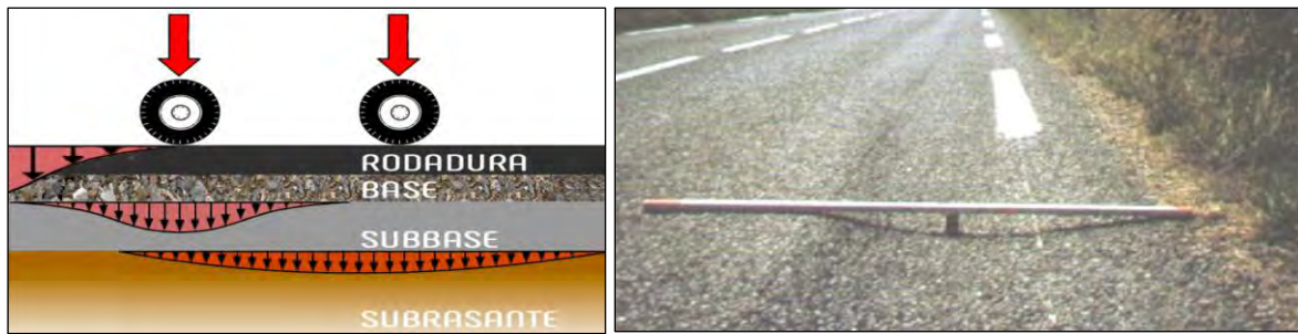
Figura 17. Ubicación de la subrasante y verificación de su falla
