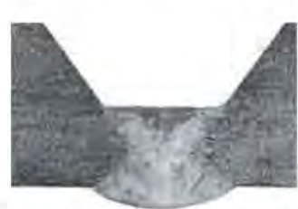
El paso de raíz abierta con STT® proporciona un espesor de ligamento de soldadura de aproximadamente 0.22 in.
