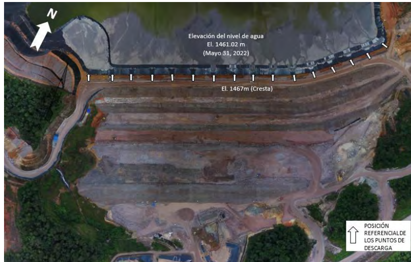
Figura 3-11 Distribución de los puntos de descarga de relaves (Adaptado de KCB, 2022)
