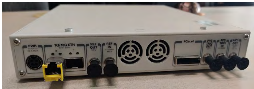
Figura 3.13: SDR de Ettus Research modelo USRP X310. Los conectores RF se encuentran del lado opuesto.
