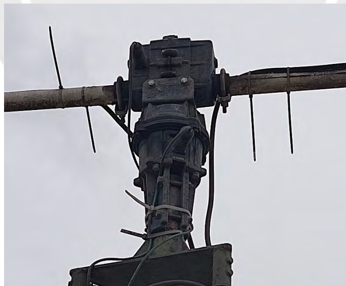
Figura 3.4: Par de rotores azimut-elevación Yaesu G5500 del arreglo de antenas Yagi para banda UHF.
