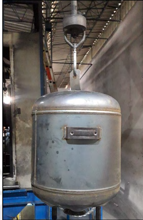
Figura 26: Colgador de tanque
