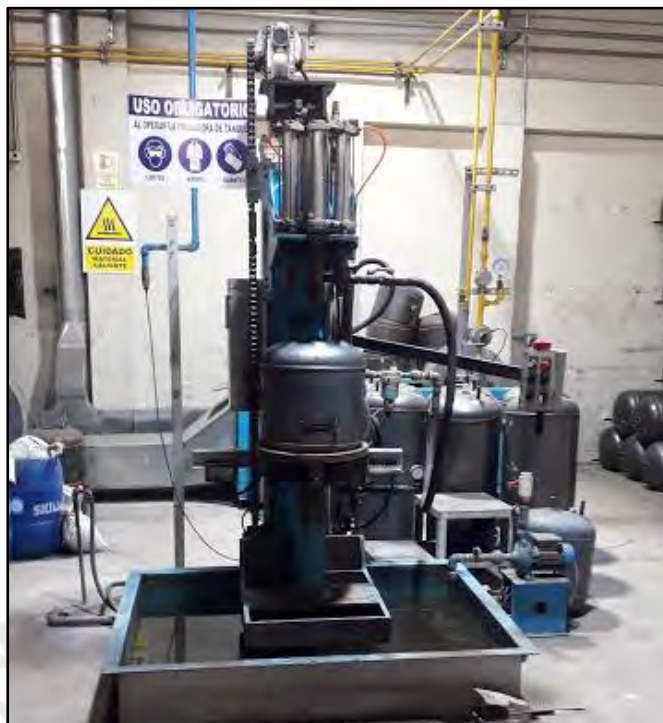
Figura 39: Prueba hidroneumática de tanque conformado
