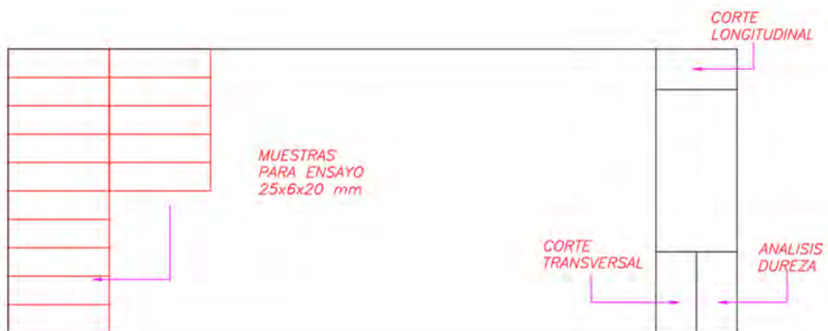
Figura 2.17 Esquema de corte de las muestras a emplear para el ciclo térmico.
