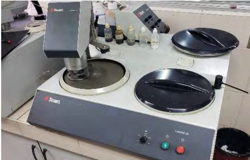
Figura 2.5 Equipo de preparación metalográfica Marca STRUERS modelo LaboPol-25 del laboratorio CITE Materiales.
