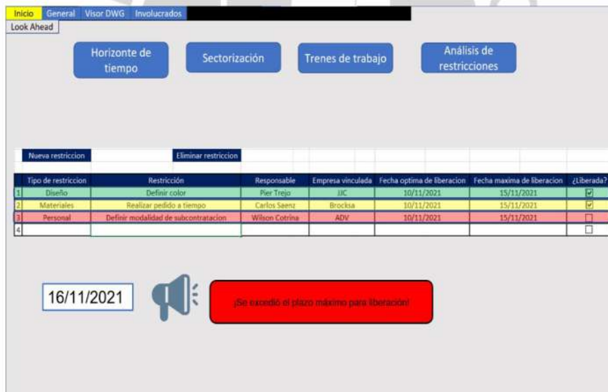
Figura 44. Sistema semafórico en la liberación de restricciones en la plataforma
