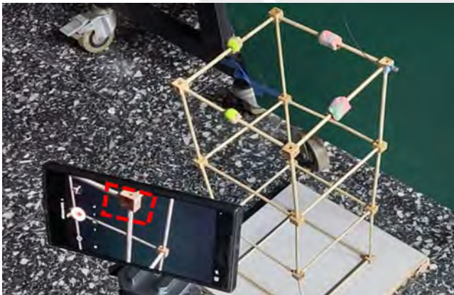
Fig. 34. Montaje experimental para registrar el movimiento de la estructura.
