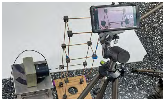
Fig. 20. Uso de un actuador electrodinámico para inducir vibración en una estructura reticulada y recolección de datos para el análisis de las señales.
