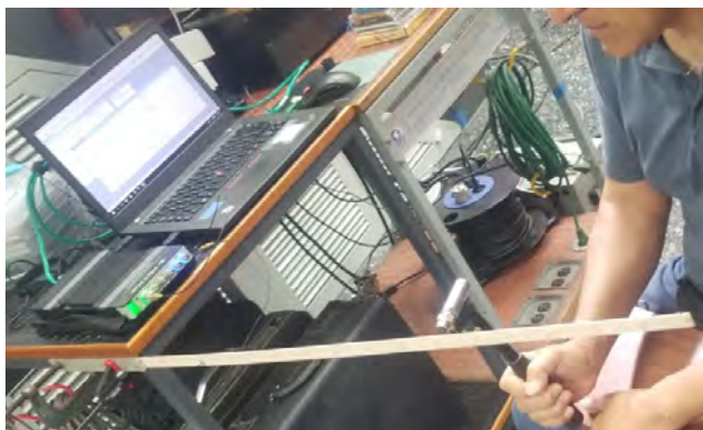
Fig. 13. Excitando una viga en voladizo de madera balsa con un martillo de impacto y recolección de datos para el análisis de las señales.
