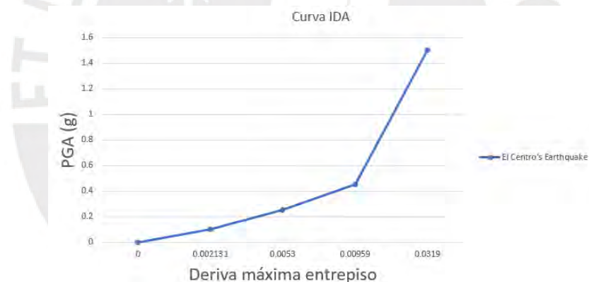
Figura 22: Diagrama de curva IDA - El Centro Earthquake-
