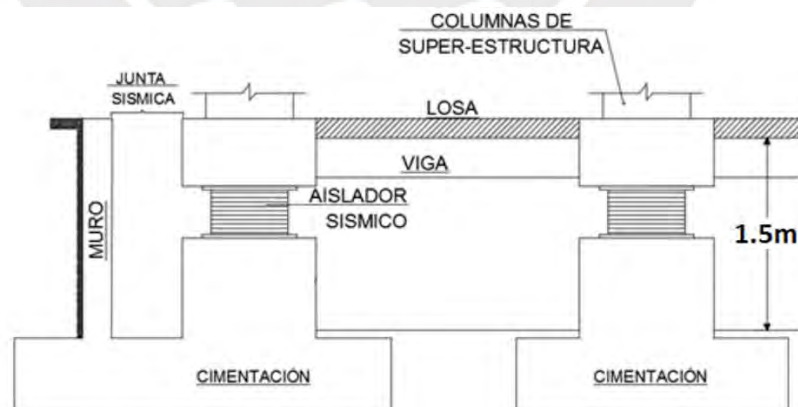
Figura 6: Semisótano de Inspección
