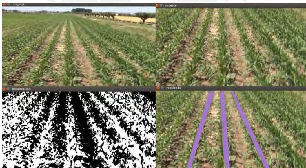
Figura 2. 34: Resultado de detección de líneas de cultivo. (a) Imagen original. (b) Recorte de la imagen de interés. (c) Imagen después de la binarización, erosión y dilatación. (d) Resultado final.
