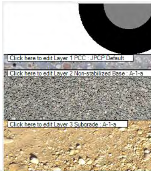
Figura 57. Estructura de los materiales de las capas del pavimento diseñado.
