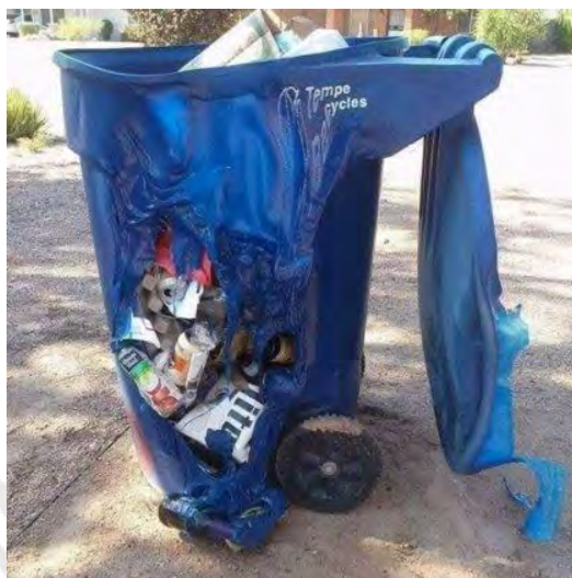
Figura 8. El tacho de basura se derrite por efectos del calor (termoplástico)
