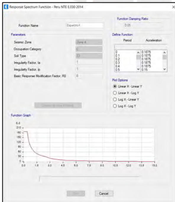
Figura 7 Parámetros: función del espectro de respuesta en ETABS
