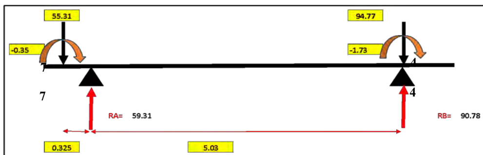
Figura 53 Modelo de análisis - zapata conectada: dirección longitudinal y sentido antihorario
