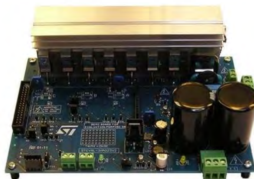
Figura 5.2 Inversor trifásico de 2 niveles STEVAL-IHM023V3
