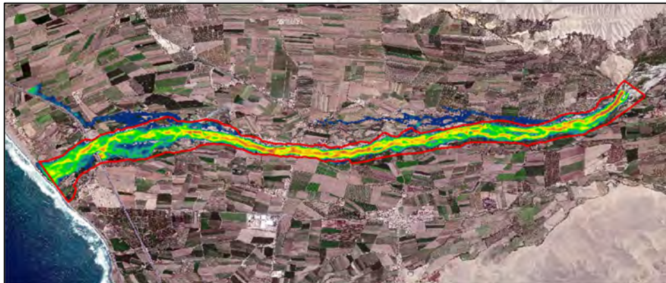
Figura 58: Comparación entre faja marginal existente y huella de inundación máxima TR 50 años Fuente: Elaboración propia
