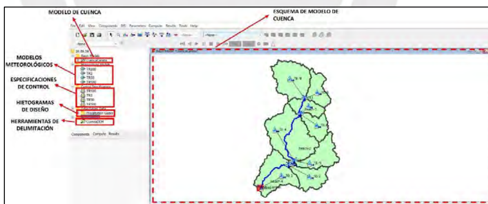
Figura 25: Componentes de modelo hidrológico elaborado Fuente: Elaboración propia con base en resultados de HEC-HMS
