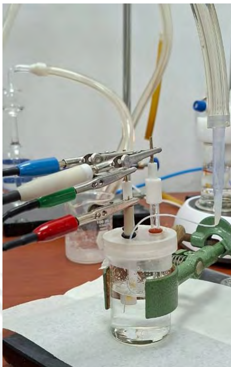
Figura 16. Celda de tres electrodos para electroanálisis (CV y LSV)
